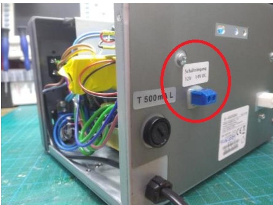
...fertig. Eine zweiadrige Litze von den beiden Anschlüssen zum Shack-Netzteil genügt nun, und das Rotor-Steuergerät automatisch mit den anderen Geräten ein- und auszuschalten.
